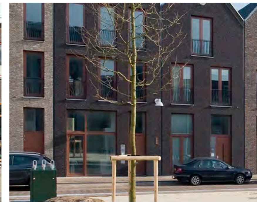
De plint is uitnodigend, minimaal 4 meter hoog en in samenhang met de bovengelegen verdiepingen ontworpen.
