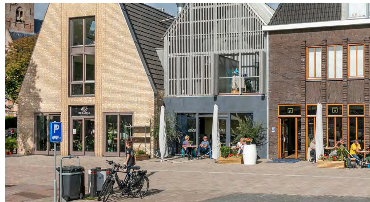
De plint is uitnodigend, minimaal 4 meter hoog en in samenhang met de bovengelegen verdiepingen ontworpen.
