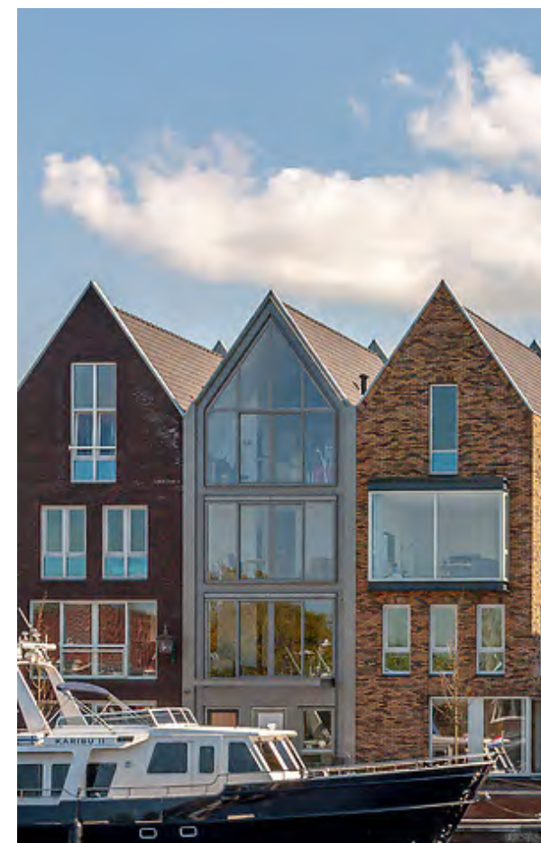
De gevelgeleding is verticaal en kent een symmetrische opzet in 3 delen
